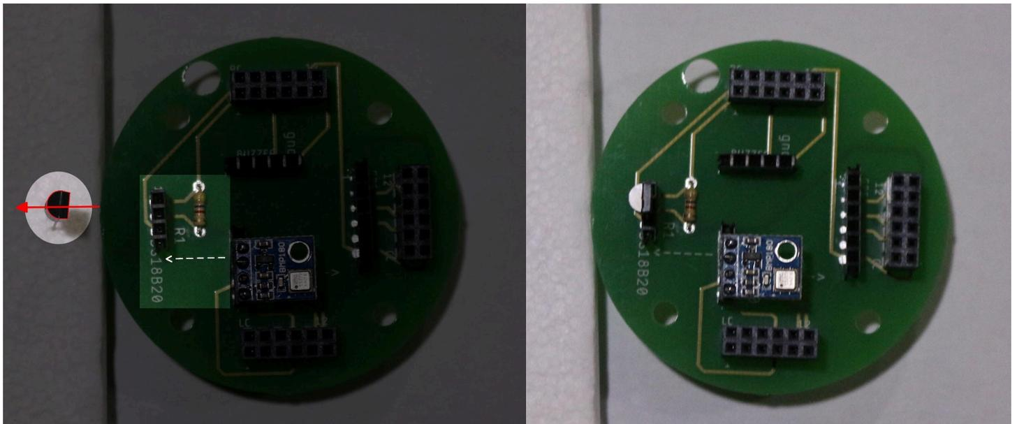
3. Encaixar *buzzer* no *pin header* marcado com “BUZZER”. O pino mais curto (-) deverá ir para a ponta do *header* marcada com “gnd”, o mais longo (+) pode ser encaixado em qualquer um dos restantes buracos. Dependendo do modelo do buzzer o pino mais longo (+) poderá ser acompanhado por uma marca no topo ou na lateral.
